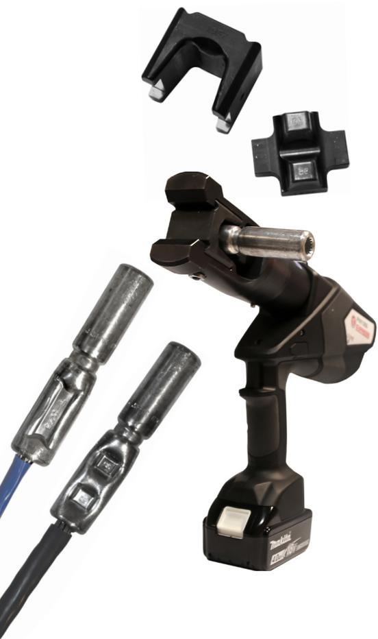
Einzigartiges System für das Aluminiumpressen im 1300-System. Das System ist für Niederspannungsanwendungen (1 kV) ausgelegt und für unterirdische Kabelverlegung geeignet. Die Anzahl der Dorne und Matrizen ist von den vorherigen 21 Stück (einschließlich Rundpressung) auf 3 Dorne und 3 Matrizen für die Dornpressung von sowohl Rundleitern als auch Sektorleitern (Al) im Bereich 50-240 mm<sup>2</sup> reduziert.
